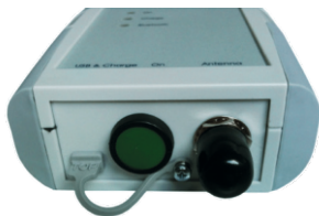
port Mini USB, przełącznik ON/OFF oraz gniazdo do podłączenia zewnętrznej anteny
