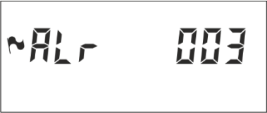
Rys. 3 Przykład wyświetlacza z flagą alarmu i kodem alarmu
