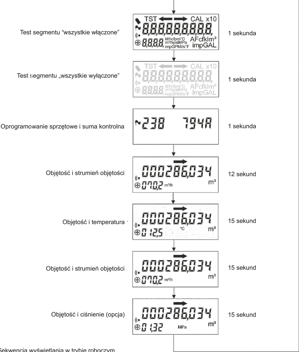
Rys. 2 Sekwencja wyświetlania w trybie roboczym
